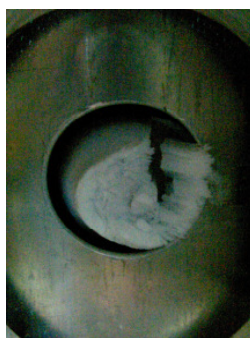
5.4.6.-1. ábra. Túl nagy mátrix-kúp, a mérő fej elfordítása után
