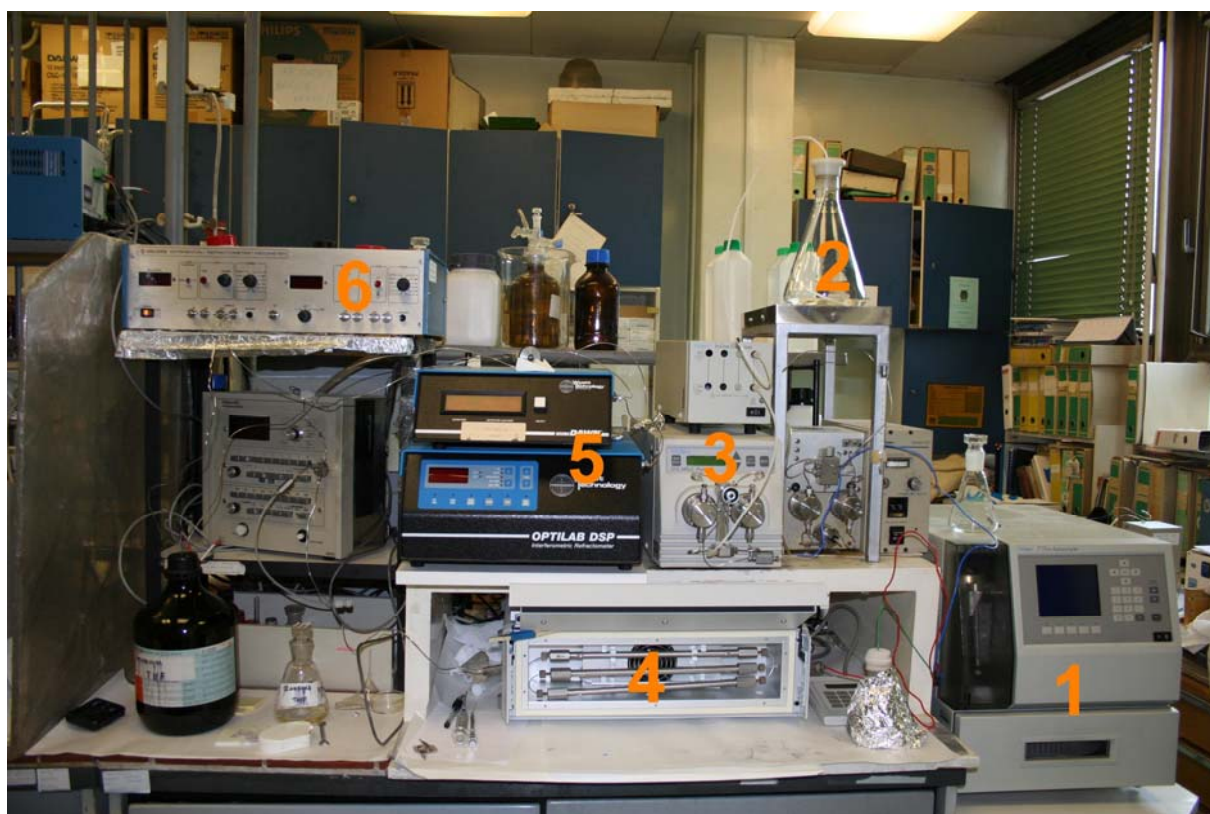
10.ábra: A mérés során használt GPC berendezés és részei (1 = automata injektor, 2 = eluens tartó, 3 = HPLC pumpa, 4 = GPC oszloprendszer, 5 = fényszóródás detektor, 6 = kettős, refraktív indexet és viszkozitást mérő detektor)
