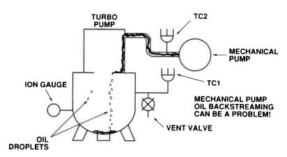
INVERTED TURBO PUMP SYSTEM ROUGHED THROUGH TURBO PUMP
