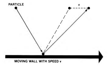
PRINCIPLE OF THE TURBOMOLECULAR PUMP
