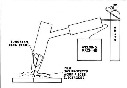
TIG (TUNGSTEN INERT GAS) OXIDATION-FREE WELDING
