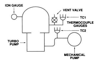
TURBO PUMP SYSTEM ROUGHED THROUGH TURBO PUMP
